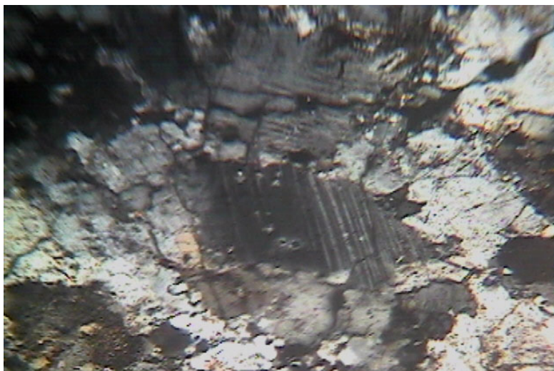
Fig. 1. Feldspat plagioclaz maclat polisintetic. X 40; N+.
